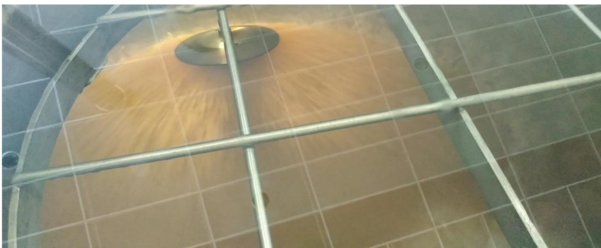
Figuur 2 – Wort dat het schuim afbreekt vanwege deflectoreffect in de ketel
